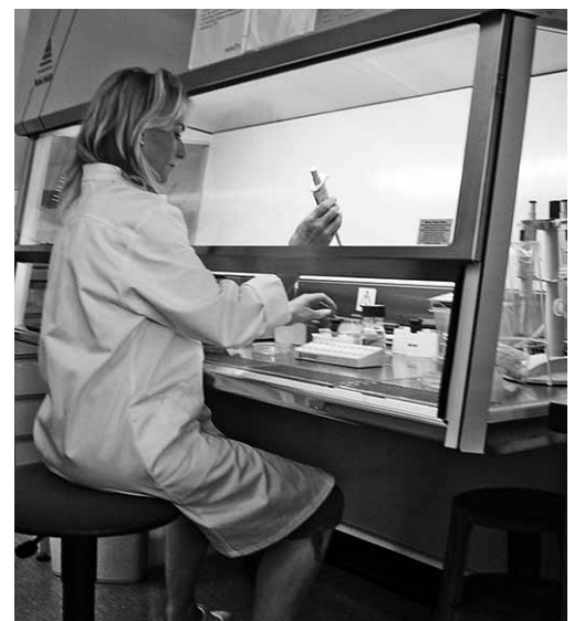
Bild 1: Schutz vor Aerosolen durch Einsatz einer mikrobiologischen Sicherheitswerkbank.
